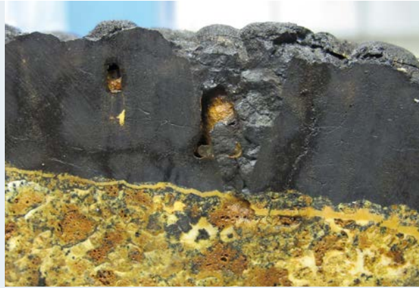
Probe aus ca. 1.700 Meter Wassertiefe von einem Seamount der Louisville-Kette im Südwest-Pazifik. Die Krusten aus dieser Region enthalten bis 1,6 Prozent Kobalt und sind signifikant angereichert an Seltenen Erden, Molybdän und Titan. Foto: BGR
