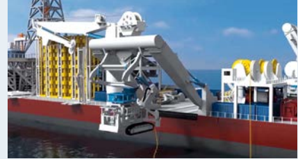
1: Aussetzen der Crawler vom Abbauschiff, in dem sich auch Fördersystem und Erzlagerräume befinden.
