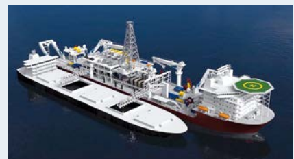
5: Die Massivsulfide werden auf ein Transportschiff umgeladen, das die Erze zur Weiterverarbeitung an Land befördert. Bildserie: © Nautilus Minerals
