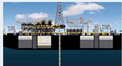
4: Auf dem Schiff werden die Erze von Wasser und Sediment getrennt und in die Lagerräume befördert.
