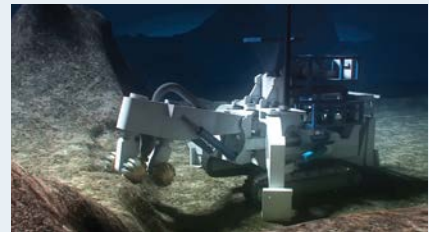
2: Einsatz der Gesteinsfräse zum Aufbrechen der Massivsulfide am Meeresboden.
