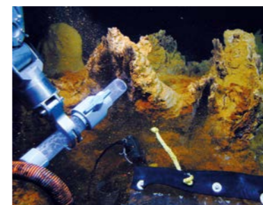
● Beprobung an einem Hydrothermalsystem, an dem sich kein mineralischer schwarzer Rauch bildet. Foto: GNS Science
