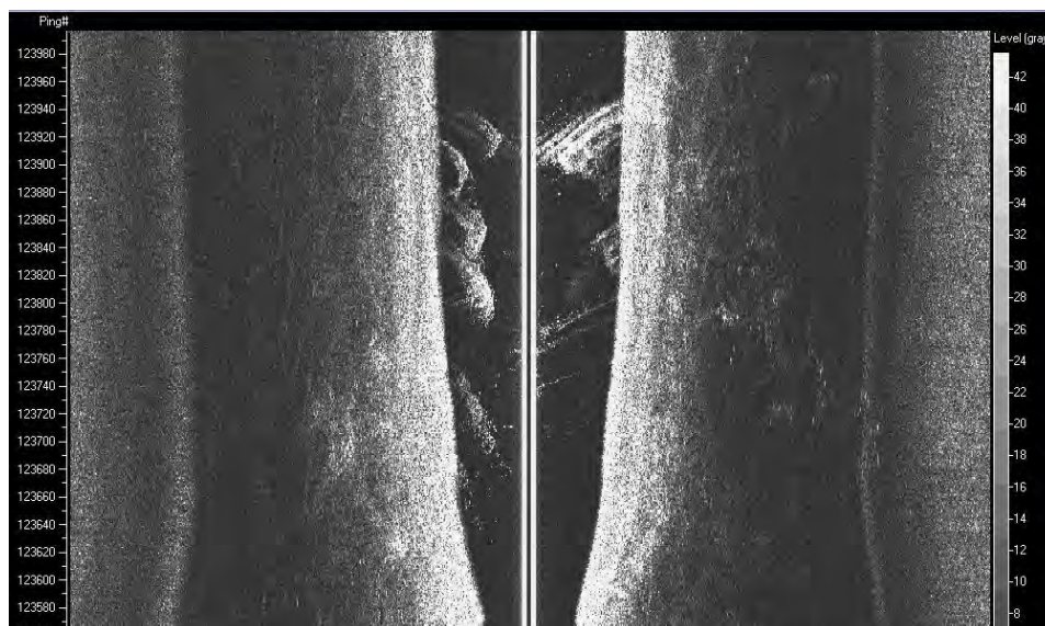
Eine Sidescan Aufnahme eines Gasblasenfelds. Die Blasenfahne in der Wassersäule ist besonders gut in dem schwarzen „Totbereich“ des Sidescan in der Bildmitte zu erkennen
