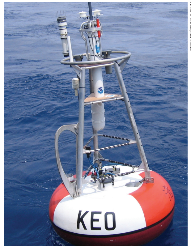
Eine verankerte Messboje der National Oceanic and Atmospheric Administration (NOAA) im Pazifik. Sie misst den \text{CO}_2 -Austausch zwischen Ozean und Atmosphäre.
