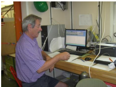
Gert Petrick am GC/MS zur Bestimmung von halogenierten Spurengasen aus Meerwasser.
