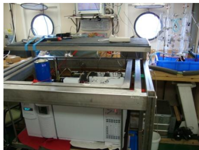
Gert Petrick am GC/MS zur Bestimmung von halogenierten Spurengasen aus Meerwasser.
