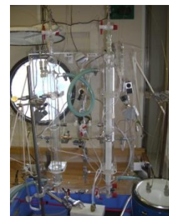
Gert Petrick am GC/MS zur Bestimmung von halogenierten Spurengasen aus Meerwasser.
