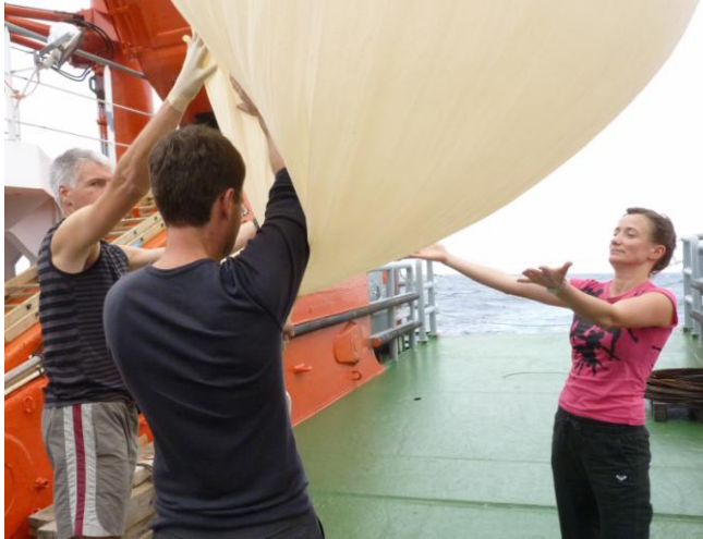
In diesem Fall versagten Susann's magische Hände. Trotz erfolgreichen Starts bei 15m/s Wind endete dieser Ozonsondenaufstieg vermutlich aufgrund einer fehlerhaften Batterie als Misserfolg.
