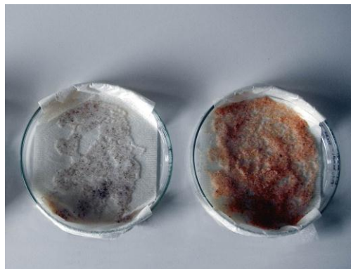
Abbildung 10: Nach dem die Mikroplastikkügelchen 2 Woche lang im Meer inkubiert worden waren, zeigte das Material an den belasteten Standorten meist eine deutliche Färbung.
