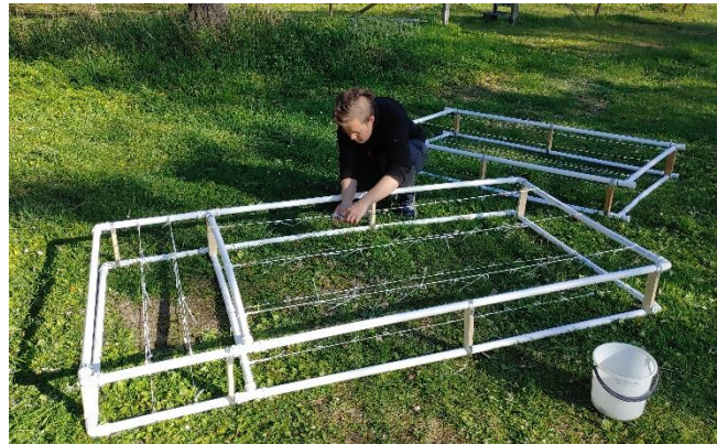
Abbildung 12: Versuchsvorbereitungen am Standort Husö. Die Rahmenkonstruktion trug die Besiedlungsplatten, die vertikal ausgerichtet und in Reihen angeordnet wurden.
