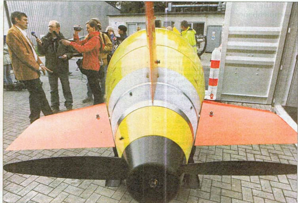
Das Leibniz-Institut für Meereswissenschaften (IFM-GEOMAR) stellte das autonome Unterwasserfahrzeug (AUV) gestern der Öffentlichkeit vor. 3,98 Meter lang und 885 Kilogramm schwer ist das Forschungsgerät. Fotos Rebehn
