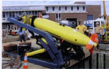
Messstation „Abyss“: Per Autopilot dringt das unbemannte U-Boot des IFM-Geomar bis in 6000 Meter Tiefe vor, um den Meeresboden zu kartieren.
