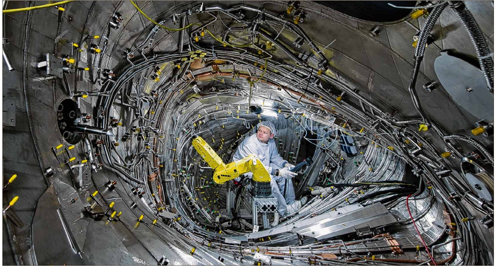
Ein Monteur arbeitet im reifenförmigen Reaktor der Forschungsanlage „Wendelstein 7-X“ in Greifswald (Mecklenburg-Vorpommern). Seit wenigen Wochen wird der Fusionsofen beheizt. Dabei wurden bereits Temperaturen von 80 Millionen Grad Celsius erreicht. Foto: dpa
