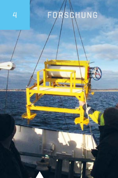
Der sensorbestückte COSYNA-Knoten für Boknis Eck wird vom Kieler Forschungskutter LITTORINA aus abgesetzt.
