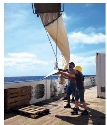
Titel: Während der Expedition MSM61 wird ein Multinet eingesetzt, um mehr über die Verteilung des Mesoplanktons am Senghor Seamount zu erfahren. Foto: Lisa-Marie Ode
