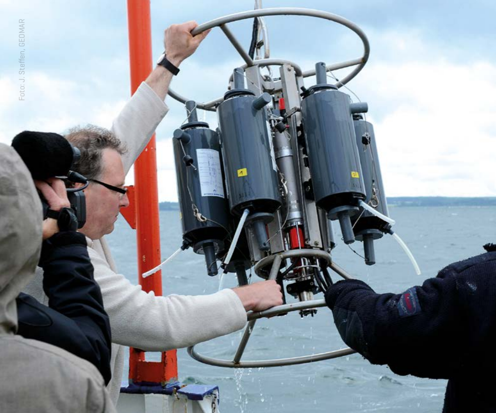
Von 1957 bis 1975 führen die Forschungsschiffe HERMANN WATTENBERG und ALKOR [1] nach Boknis Eck. Seit 1975 wird die Probenahme hauptsächlich mit FK LITTORINA durchgeführt. Nach wie vor ist ein Wasserschöpfer das wichtigste Gerät zum Sammeln der Proben. Foto: Archiv GEOMAR.
