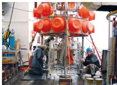
Vorbereitungen des BIGO Landers zur Gewinnung von biogeochemischen Daten. Foto: Peter Linke, GEOMAR.
