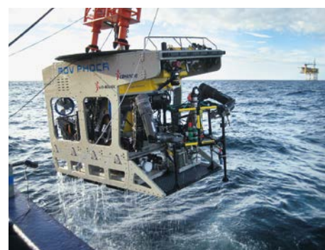
Aussetzen von ROV PHOCA zur Platzierung und Überwachung hochpräziser Messgeräte am Meeresboden. Im Hintergrund die Förderplattform Goldeneye. Foto: Dirk Koopmans, MPI
