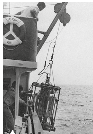
Von 1957 bis 1975 führen die Forschungsschiffe HERMANN WATTENBERG und ALKOR [1] nach Boknis Eck. Seit 1975 wird die Probenahme hauptsächlich mit FK LITTORINA durchgeführt. Nach wie vor ist ein Wasserschöpfer das wichtigste Gerät zum Sammeln der Proben. Foto: Archiv GEOMAR.
