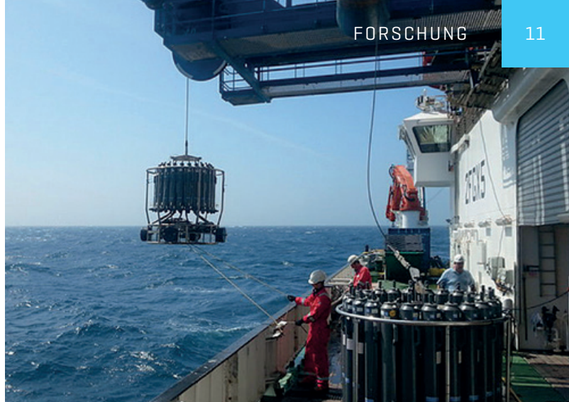
Die Analyse von Blei in Meerwasser stellt wegen der relativ niedrigen Konzentrationen eine besondere Herausforderung dar. Die Probenahme muss mit spurenmethallfreien Kranzwasserschöpfers durchgeführt werden, um Kontaminationen durch die Beprobung auszuschließen. Foto: Dagmara Rusiecka / GEOMAR
