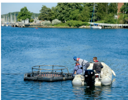
Ein in GoJelly entwickeltes, experimentelles Zuchtbecken für Quallen, der sogenannte Flow2Vortex, könnte sich ganz nebenbei in Küstennähe auch als Mikroplastikfalle eignen. Erste Testläufe finden derzeit in Kiel statt. Foto: Jan Steffen / GEOMAR
