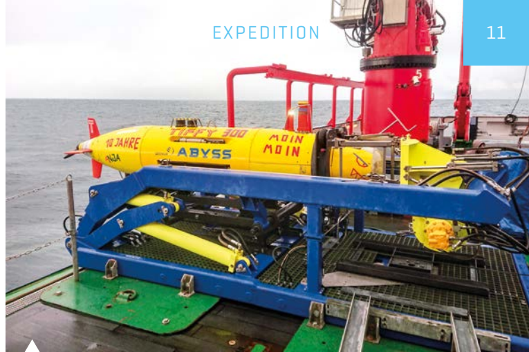
Tiffy wartet, liebevoll dekoriert, in ihrem Aussetzrahmen auf ihren 300. Tauchgang. Seit 2008 hat das AUV 3.500 Stunden unter Wasser verbracht und eine Gesamtstrecke von über 18.000 km am Meeresboden zurückgelegt. Damit ist es eines der erfolgreichsten Fahrzeuge seiner Art und für Untersuchungen, wie sie auf der Expedition MSM75 durchgeführt wurden, unverzichtbar. Foto: Emanuel Wenzlaff / GEOMAR
