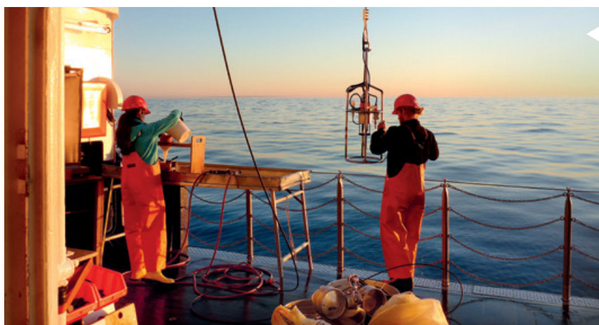
Filtration von Proben aus einem Planktonnetz (links) und Messung von Wasserparametern mit der CTD-Sonde (rechts) im Arkonabecken während der Fahrt AL521. Foto: Jan Dierking / GEOMAR
