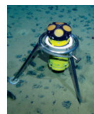
Hochauflösende Sensoren zur Messung der Trübung (links) und Strömungsgeschwindigkeit (rechts). Um die räumliche Ausbreitung der suspendierten Sedimentwolke zu erfassen, wurden mit dem ROV am Meeresboden Plattformen mit Messgeräten positioniert. Foto: ROV-Team / GEOMAR
