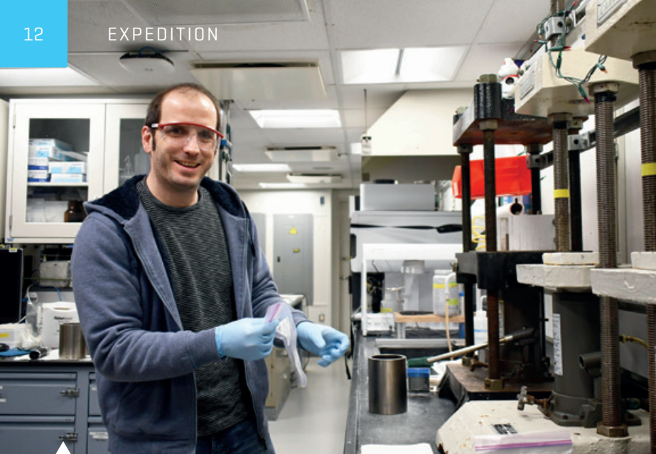
Marcus Gutjahr im chemischen Labor an Bord der JOIDES RESOLUTION. Mit den hydraulischen Pressen [rechts] wird den Sedimentkernen Porenwasser entzogen, um dessen chemische Zusammensetzung zu bestimmen. Foto: Marlo P. Garnsworthy
