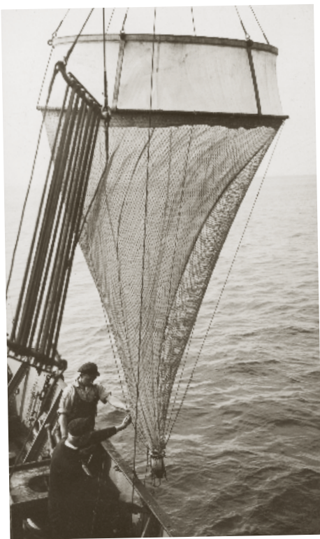
Einholen eines Planktonnetzes mit Sedimentfalle
