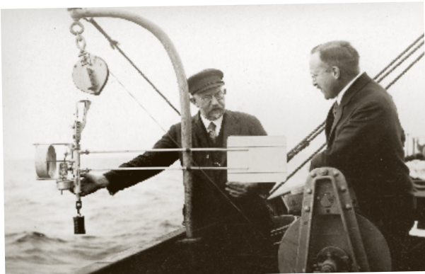
Schiffskapitän Hatje und der Ozeanograph Prof. Dr. Bruno Schulz beim Ausbringen eines Strömungsmessers
