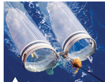
Bongo-Netz, bestehend aus zwei Elementen. Das Netz-Duo wird seitlich etwa 30 Minuten lang in 50 Metern Tiefe geschleppt, um Schwebeteilchen und Zooplankton zu sammeln.
