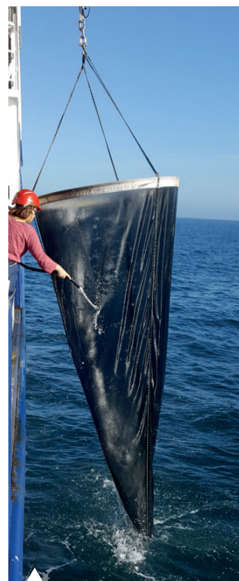
WP3-Netz mit 1,5 Meter Durchmesser. Das Netz wird auf 100 Meter abgesenkt und vertikal geschleppt, um Quallen und ihr aufgenommenes Mikroplastik aufzufangen.
