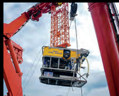
ROV KIEL 6000 am A-Rahmen-Kran des Forschungsschiffs SONNE. Während der Expedition S0276 absolvierte der Tauchroboter seinen 300. Tauchgang. Foto: Mia Schumacher/GEOMAR
