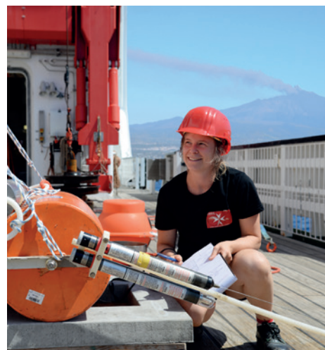
Dr. Morelia Urlaub checkt während der Expedition S0277 eine Geodäsie-Station zur Messung von Bewegungen des Meeresbodens am Ätna. Foto: Thore Sager / GEOMAR
