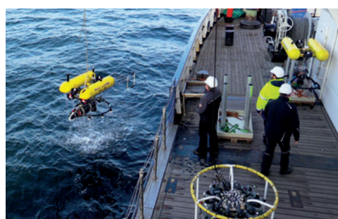
Einholen von AUV LUISE mit integriertem Sensor für magnetische Messungen. Foto: Torsten Frey / GEOMAR
