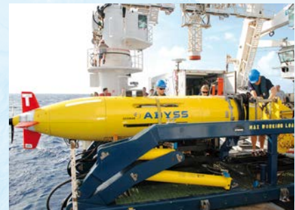
▲ An Bord: Das autonome Unterwasserfahrzeug AUV ABYSS wird für den Einsatz bereit gemacht. Foto: Evi Nomikou, Universität Athen
