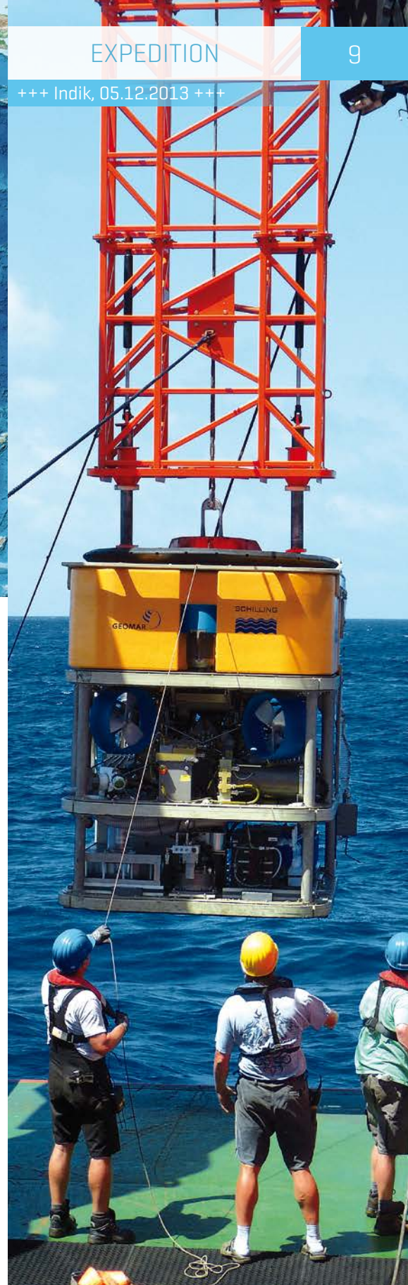
▲ Bergung des über 100 Kilo schweren zinkreichen Schlotfragments aus 3320 Meter Wassertiefe. Foto: ROV-Team, GEOMAR
