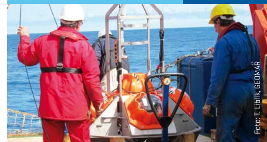
Die geöffnete Boje mit noch intakter Elektronik. Foto: T. Böschen, GEOMAR
