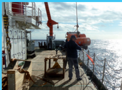
▲ Ausbringen eines Ozeanbodenseismometers. Foto: Dietrich Lange, GEOMAR
