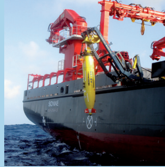
▲ Das AUV ABYSS des GEOMAR wird vor einem Tauchgang von Bord der SONNE gehievt. Foto: Oliver Meyer
