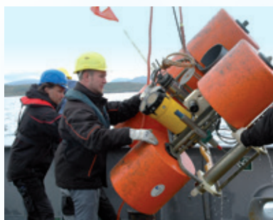
▲ Ein „Lander“ wird nach einem Jahr geborgen. Das Gerät erfasste die Lebensbedingungen der Kaltwasserkorallen am Boden des Trondheimsfjords.
