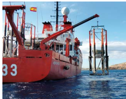
▲ Ausbringen der Mesokosmen von Bord des spanischen Forschungsschiffs HESPERIDES in der Bucht Bahia de Gando, Gran Canaria. Foto: Ulf Riebesell, GEOMAR
