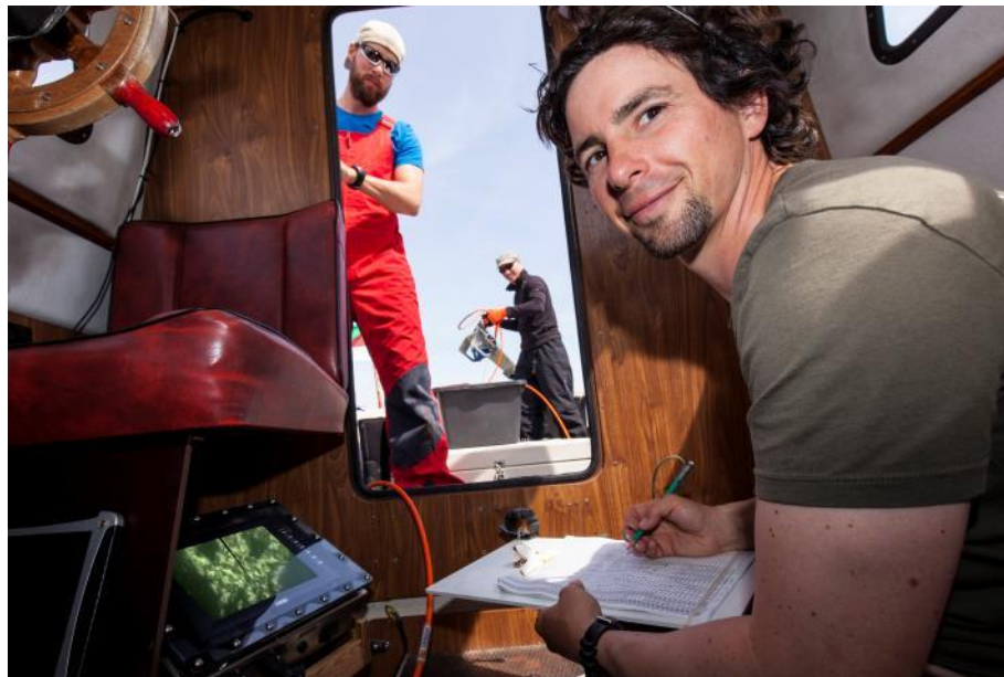
Abbildung 3: Schleppkamera im Einsatz auf dem HUNTER: über das orangefarbene Zugkabel wird einerseits die Stromversorgung der Kamera sichergestellt, andererseits das Videosignal der GoPro nach oben auf den Monitor (links) geleitet. Das System erfordert insgesamt drei Decksleute: einen Kamera-Operator, einen Schiffsführer und eine Deckshand für das Kamera-Handling, Notfälle und Kommunikation.
